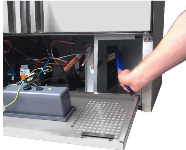
4. Entfernen Sie den Staubfilter und reinigen Sie ihn gründlich. Ein verschmutzter Filter kann die Kühlleistung beeinträchtigen und dazu führen, dass der Kompressor überhitzt oder nicht mehr effizient arbeitet.
